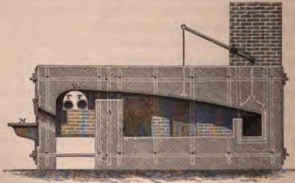
Fig. 205. — Appareil Deville pour la fabrication du sodium (coupe longitudinale).
